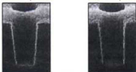
Рис. 1. Контактные отверстия 0,3 мкм 0,35 мкм
